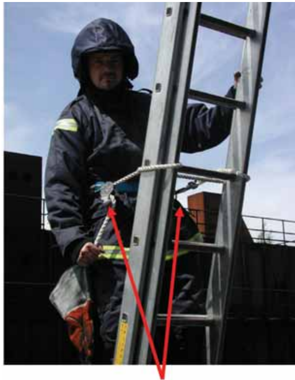
Støtteline monteret i D-ringene i støttebæltet
