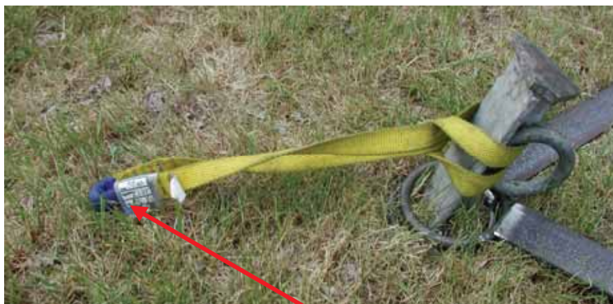
Forankring med rundsling og særlig forstærkning, hvor karabinen fastgøres
