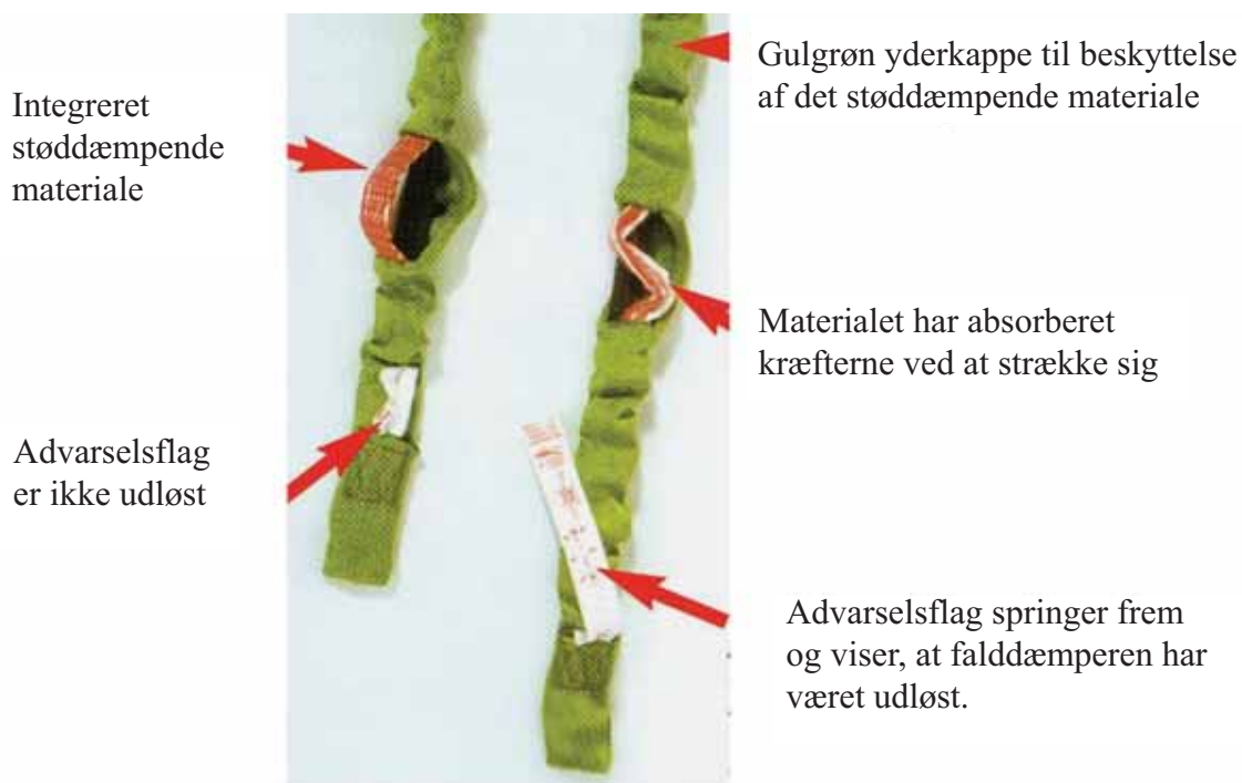
En falddæmper før og efter et fald
