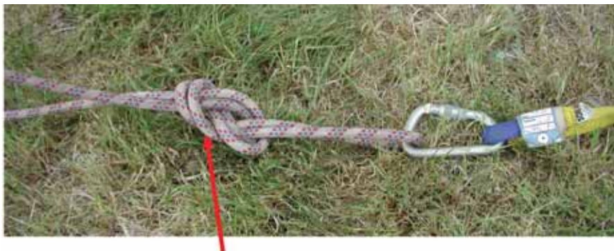
Tovværket kortes op med et dobbelt ottetalsknob, og fæstnes i rundslingen med en karabin
