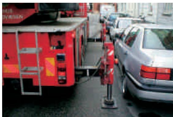
Fuld understøtning i højre side, der giver mulighed for fuldt arbejdsområde i denne side
