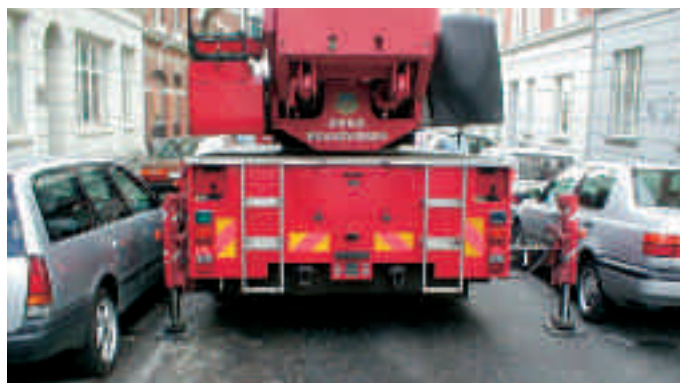
Variabel understøtning. Chaufføren er kørt til den modsatte side af, hvorfra der skal reddes
